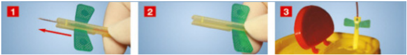
Bild 2, Folge 1-3: Nach Entfernung der speziellen Flügel- oder Butterfly-Kanüle aus der Patientenvene rastet die Kanüle nach einhändigem Zurückziehen in den Kanülenschutz ein und kann gefahrlos entsorgt werden.
